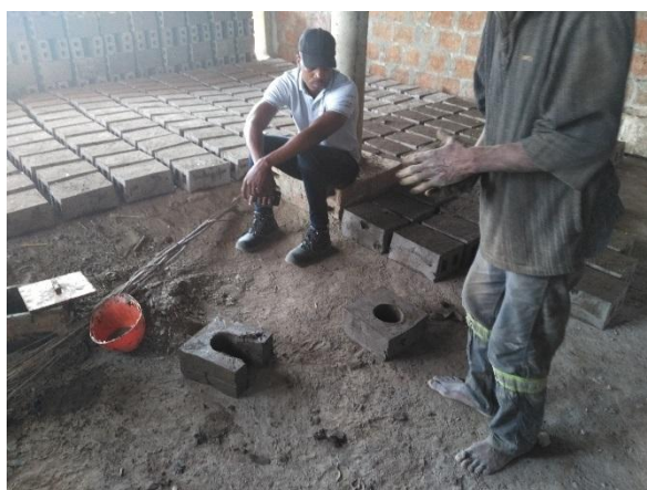
Figura 8: Fogão poupa lenha de baixo custo feito de argila no distrito da Manhiça em processo de produção
